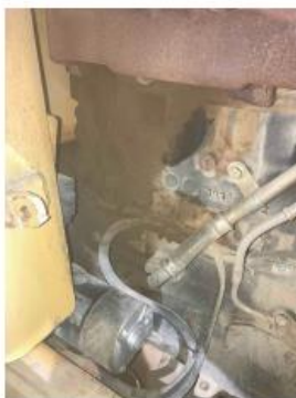
Image Comment(s):Fuga en empaquetadura.
