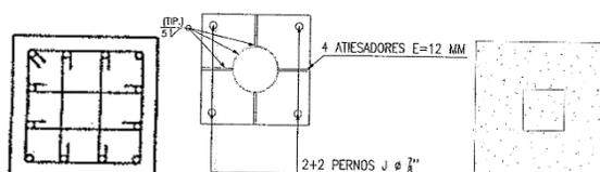
Detalle pedestal, placa base y planta fundación referencial
