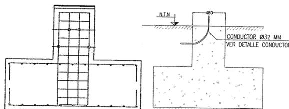
Detalle armadura y elevación fundación referencial.
